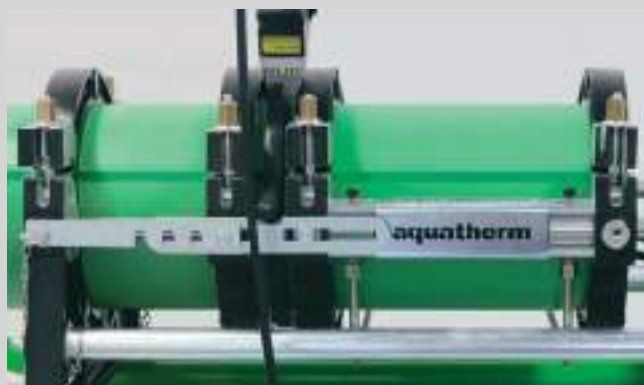
Вставка сварочного элемента
