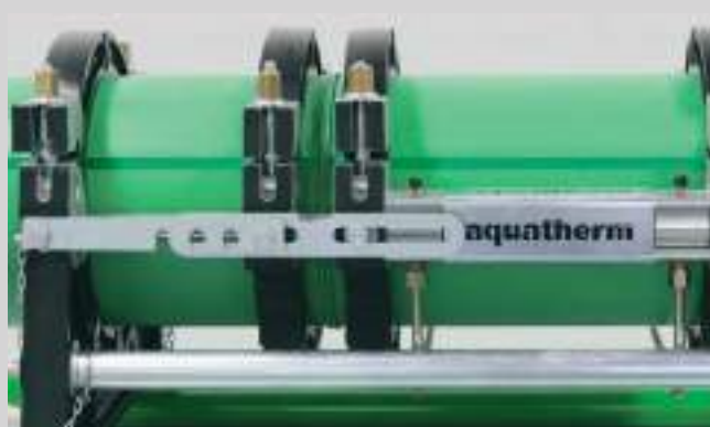
Трубы свести под давлением дать соединению остыть
