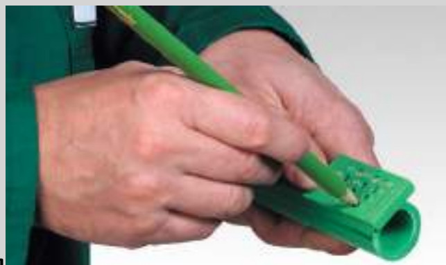
Отметка глубины сварки
