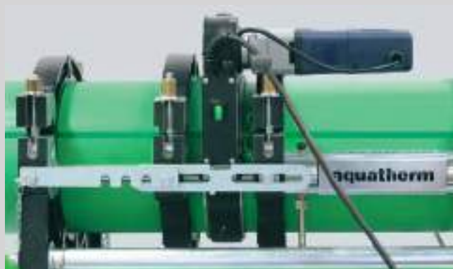
Свариваемые части вставить, выровнять и зафиксировать
