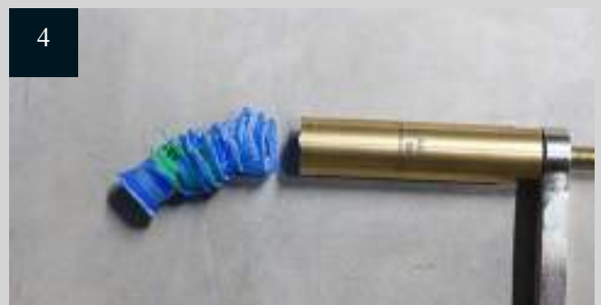
Удаление отходов сверления из инструмента
