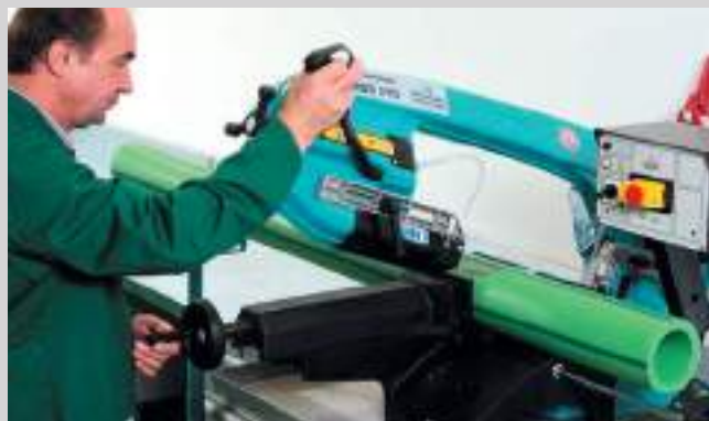
Перед сваркой отрезать трубу на необходимую длину
